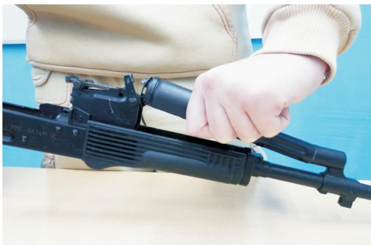
*Фото 12 – отделение газовой трубки*
