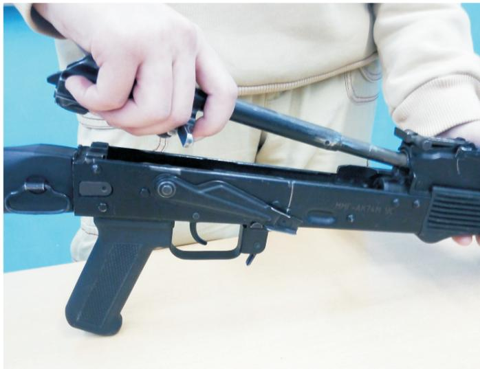
*Фото 10 – отделение затворной рамы с затвором*
