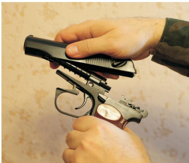
*Фото 7 – одевание затвора на возвратную пружину*
