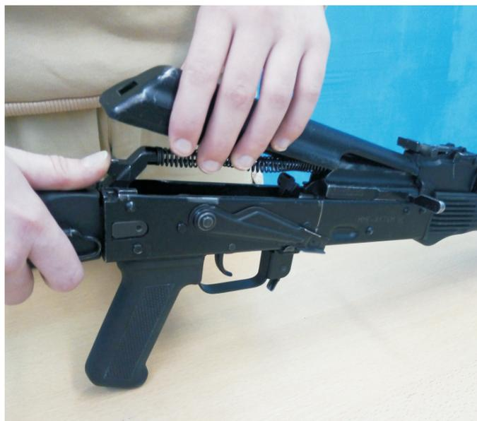
Фото 8 – отделение крышки ствольной коробки
