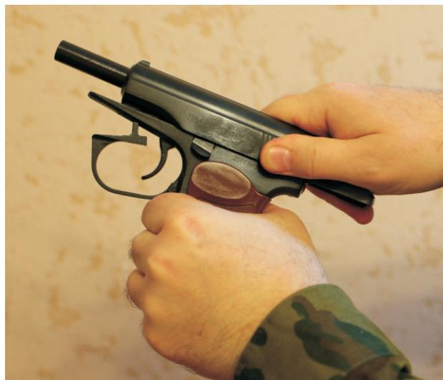
*Фото 8 – отведение затвора в крайнее заднее положение*
