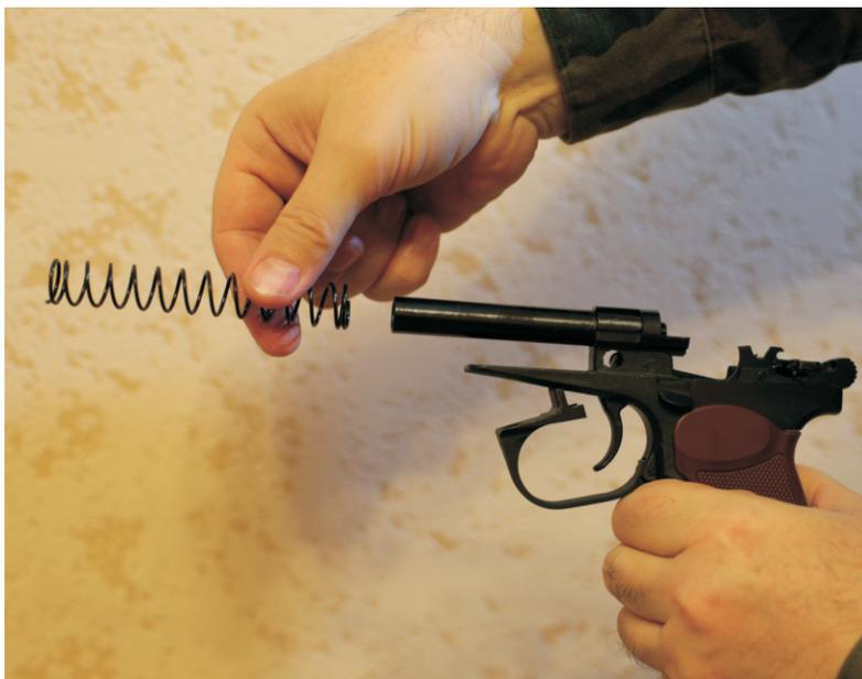
*Фото 5 – снятие возвратной пружины*
