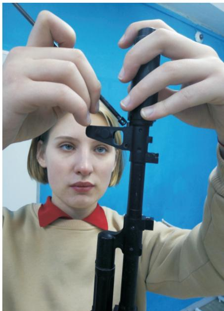
Фото 6 – отделение дульного тормоза-компенсатора с помощью шомпола
