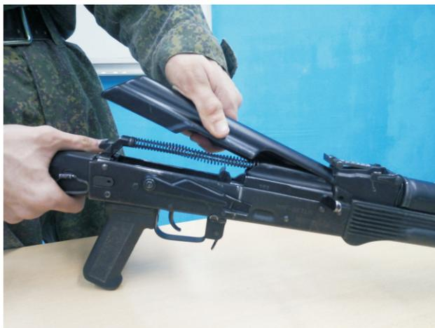
*Фото 19 – присоединение крышки ствольной коробки*
