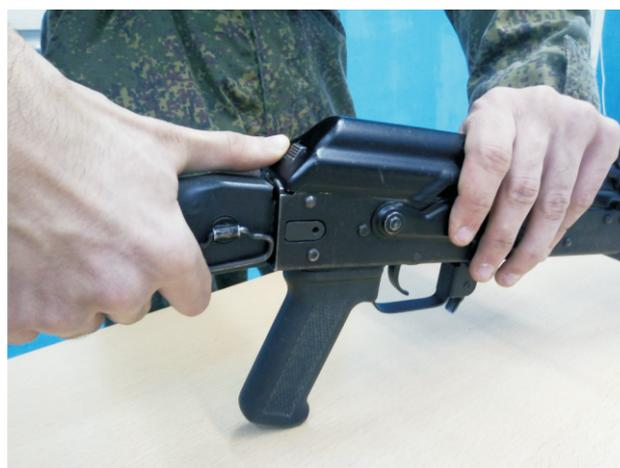
*Фото 20 – закрытие крышки ствольной коробки*
